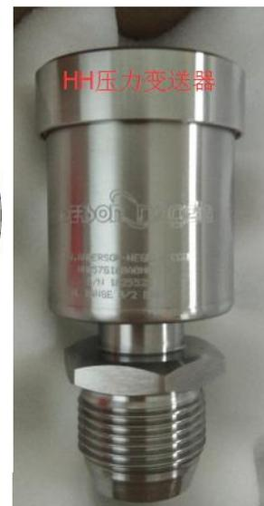
2. 如果需要对满量程做出调整, 需要将压力传感器置于标准压力源上, 给出需要的上限满量程压力值, 然后调节 SPAN 电位器, 直到电流输出为 20mA。
