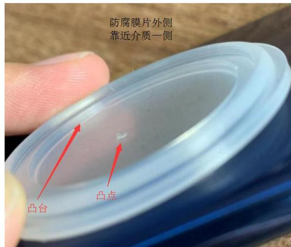
1. 防腐膜片内侧（全平面）贴合压力传感器膜片安装。如果装反，防腐膜片与压力传感器膜片之间封存大量空气，温度变化时，会导致其体积压力变化影响传感器测量。
